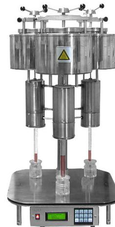
Принцип действия АДЖ-5 основан на вытеснении жидкости из пор образца горной породы за счёт избыточного давления, возникающего при термостатированном нагреве, конденсации паров и сборе конденсата для измерения объемов образованных фракций (вода, нефть).
