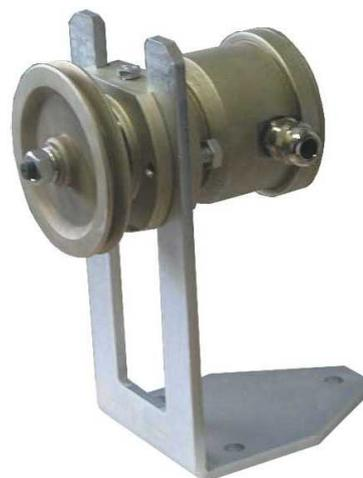
Принцип действия датчика оборотов лебедки ДОЛ-5 основан на преобразовании угла поворота вала буровой лебедки в двухфазный электрический сигнал (сдвиг фаз 90°), из которого формируются импульсные сигналы необходимой формы и величины.
