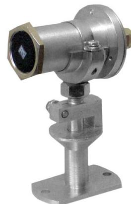
При подключении к микропроцессорному блоку системы «СКР», станции СКЦ «Раствор-М» или станции ГТИ датчик обеспечивает камерный метод измерения расхода (ГОСТ 15528-86), заключающийся в суммировании за единицу времени объемов раствора, подаваемого насосом за один цикл, которому соответствует определенное количество оборотов вала насоса.
