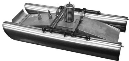
Принцип действия поплавкового дегазатора ДП-1 основан на выделении пузырьков газа из поверхностных слоев бурового раствора и отводе образующейся газовой смеси насосом системы транспортировки газовой смеси, установленным в станции ГТИ.
