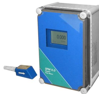
Принцип действия состоит в следующем: ультразвуковой сигнал от передающей части накладного сенсора расходомера поступает через стенку трубы в движущийся поток жидкости. Отражаясь от твердых частиц или пузырьков воздуха, сигнал возвращается в приемную часть сенсора. Частоты передаваемого и принимаемого сигналов для движущейся жидкости различаются (эффект Доплера). Контроллер расходомера измеряет сдвиг частоты и рассчитывает значение скорости потока жидкости.
