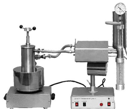
Принцип действия термовакuumного дегазатора основан на извлечении газов, содержащихся в пробе, за счёт нарушения термодинамического равновесия при создании вакуума и термостатированном нагреве шлама или бурового раствора до установленной температуры.
