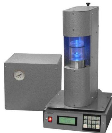
Карбонатомер имеет энергонезависимый архив результатов измерений, которые выводятся на дисплее прибора и могут быть переданы в компьютер.
