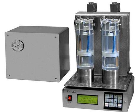
Карбонатор КМ-05А работает как в автономном режиме, так и при подключении к компьютеру (с использованием программы "Carbon", поставляемой вместе с прибором).
