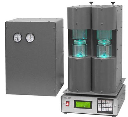
Карбонатомер КМ-05С является единственной моделью среди приборов для определения карбонатности, обеспечивающей одновременное исследование двух образцов в автоматическом режиме работы.
