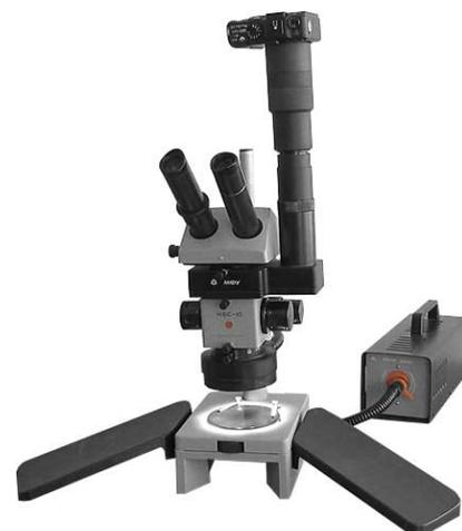
Установка МФО-1 представляет изделие на базе микроскопа МБС-10, оснащённого кольцевым волоконным осветителем для создания равномерного освещения предметного столика, микрофотографическим устройством и цифровым фотоаппаратом с матрицей высокого разрешения, установленным с помощью специальной втулки (адаптера) на монокулярной трубке.
