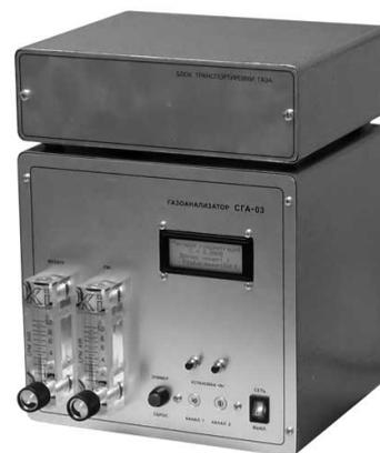
Газоанализатор СГА-03 включает два газовых датчика термокаталитического типа, плату преобразования и управления, измерительную плату АЦП на базе микроконвертора ADUC 847-й серии, плату индикации, четырёхстрочный жидкокристаллический дисплей и пневматический блок, содержащий три электромагнитных клапана, два дросселя и ротаметры для контроля расхода воздуха и газовой смеси.
