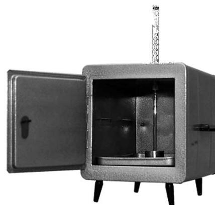
Принцип действия сушильного шкафа основан на выпаривании воды с поверхности и из пор частиц до момента окончания парообразования, определяемого по превышению значения температуры высушиваемого материала выше температуры парообразования.
