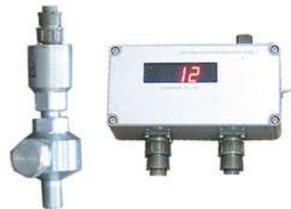
Система СКД-1 может комплектоваться датчиком для измерения давления в одном из выбранных диапазонов: 0...25, 0...40, 0...60 и 0...100 МПа.
