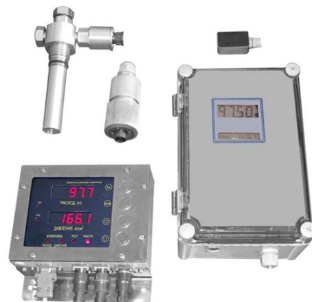
Система состоит из датчика давления ДВД-1 и ультразвукового датчика расхода ДРУ, которые подключены кабелем к разъемам блока индикации, сообщенным с блоком питания; Система «СКДР» обеспечивает:
