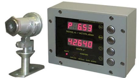
Система СКР реализует камерный метод измерения расхода жидкости (ГОСТ 15528-86), заключающийся в суммировании за единицу времени объемов жидкости, подаваемой насосом за один цикл.
