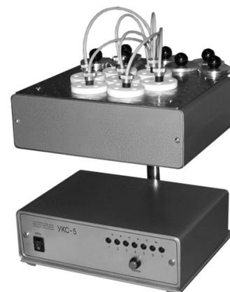
Момент окончания сушки образца отмечается световой и звуковой сигнализацией.
